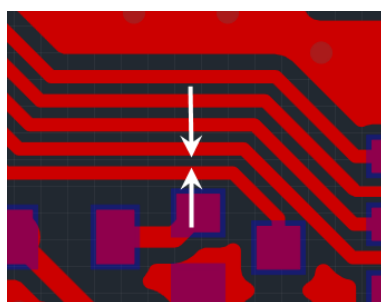
Рис. 601. Зазор между треками
