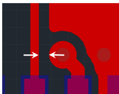
Рис. 603. Зазор между треком и переходным отверстием
