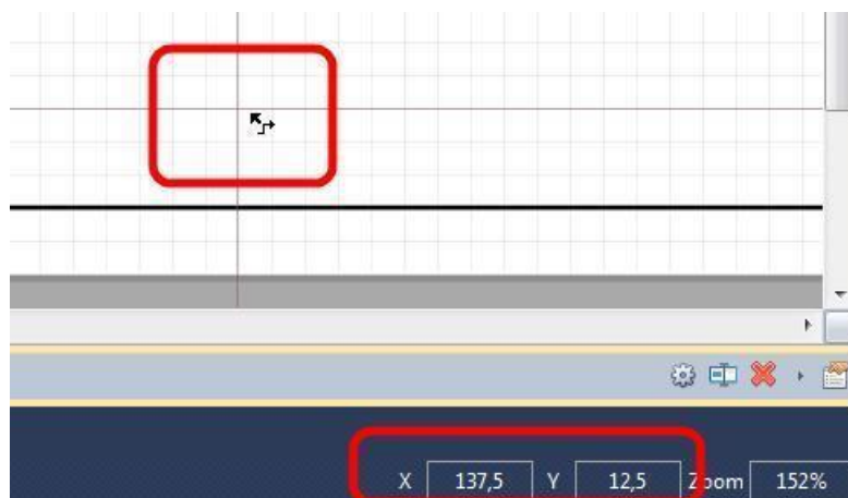
Рис. 434. Вид курсора при использовании инструмента «Разместить цепь»
