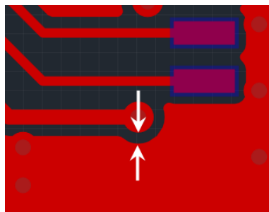
Рис. 614. Зазор между переходным отверстием и областью металлизации
