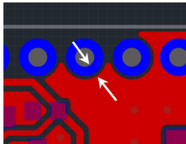
Рис. 620. Зазор между областью металлизации и любым отверстием
